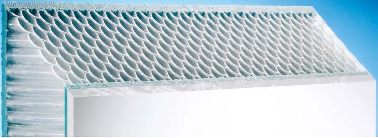
Diese Wabenkonstruktion ist ein Teil der vierschichtigen Sandwich-Verbundkonstruktion aus PVC und GFK und speziellen „honeycomb“-Platten. Neben einer sehr guten Isolierung verleiht dieser Verbund dem Schwimmbecken eine enorm hohe Stabilität in Form und Fläche.
