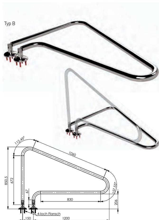
Die **klappbaren Griffbögen** lösen ein häufiges Problem bei aktuellen Außenschwimmbädern: Durch das Wegklappen des Griffbogens wird eine **Kollision mit Schiebehallen oder anderen Poolabdeckungen** vermieden.
