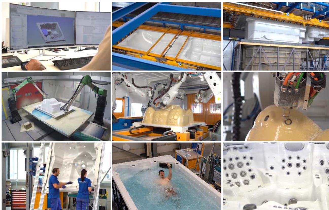
Von der Konstruktion, über das Tiefziehverfahren, Reinforcing und Cutting bis hin zur Endmontage, der Qualitätssicherung und Lagerung sind alle Arbeitsprozesse miteinander vernetzt und aufeinander abgestimmt.
